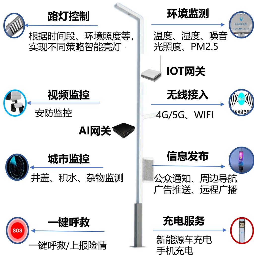
在智慧路灯杆上搭载各种传感器及感知设备，如**充电桩、LED信息发布屏、高清摄像头、应急报警、5G基站搭载网络、WiFi网络、环境监测、井盖及积水监测、城市广播**等，利用物联网及互联网技术，使路灯成为智慧城市信息采集终端和便民服务终端，是智慧城市重要的入口。
